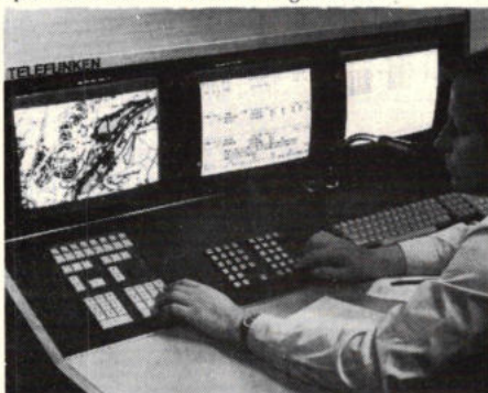
Afb. 5. Bedieningstafel met protocol en gepeilde plaats van een om hulp vragende automobilist, op beeldschermen zichtbaar gemaakt.
