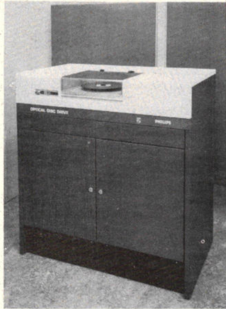
Afb. 5. Een experimentele Philips digitale optische recorder, zoals er onlangs enkele zijn gefabriceerd. Zij worden nu in verschillende studieprojecten binnen Philips toegepast om deze geheel nieuwe mogelijkheden van gegevensregistratie optimaal te leren benutten.
