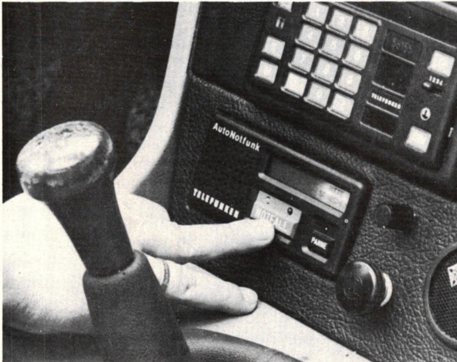
Afb. 1. Auto-noodoproep; apparaat in een personenauto ingebouwd.
